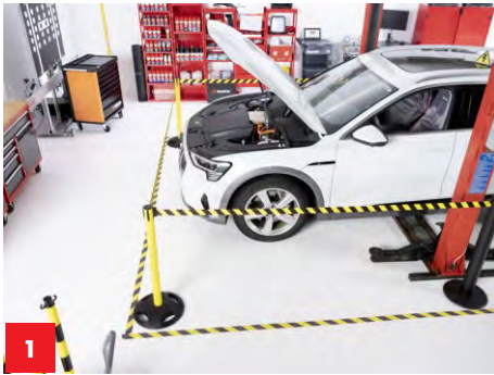
1 Pozitionati vehiculul in zona de parcare, scoateti cheia si blocati pentru a nu permite accesul persoanelor neautorizate.
