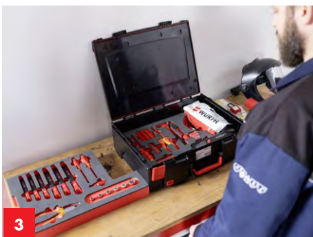
3 Pregatiti sculele si echipamentul de protectie (ochelari de protectie, scule izolate, cablu de protectie si manusi de protectie).
