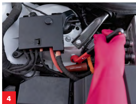
4 Opriti sistemul electric al vehiculului (12V in acest exemplu) prin deconectarea bornei negative a bateriei si izoland cablul negativ cu un manson de protectie.
