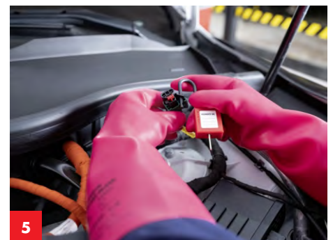
5 Opriti sistemul de inalta tensiune de la stecarul sau de la intrerupatorul instalatiei si, daca este posibi, blocati-l cu un dispozitiv pentru a preveni repornirea accidentala. Daca este un stecar de deconectare , pastrati-l intr-un loc inaccesibil pentru alte persoane.
