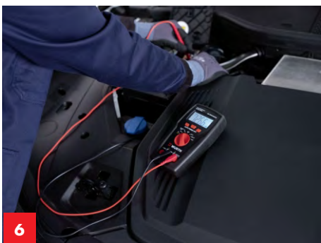
6 In functie de producatorul auto, vehiculul trebuie verificat de absenta tensiunii. Aceasta procedura poate fi gasita in documentatia vehiculului electric.
